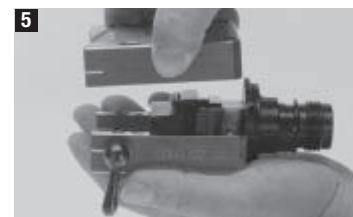
5 Aseta kuoren toinen puoli toisen päälle ja kiristä ruuvit M6x30 käyttämällä Loctitea ja kuusio-avainta.
