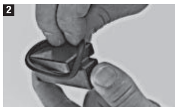
2 Asenna uusi kuminen O-rengas iskupalaan kuvan osoittamalla tavalla.
