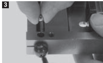
3 Introduire l'axe avec le levier de verrouillage dans l'alésage, comme ci-dessus (attention de ne pas perdre la bille!)
