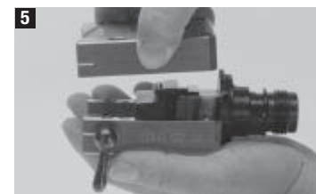
5 Sett på øvre og nedre del av stempelet og fest det med de 4 låseskruene M6×30 ved å bruke Loctite og en Umbraco nøkkel.
