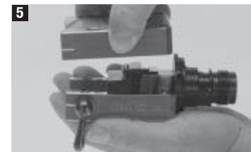
5 Sæt husets to halvdele sammen og skru de 4 skruer M6x30 i vha. Loctite og en unbraco-nøgle.
