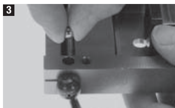
För försiktigt in axeln med låsspaken i urborningen enligt bild utan att kullagret lossnar.
