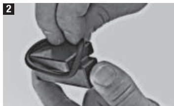
2 Monter en ny gummi o-ring på hovedet som vist på billedet.
