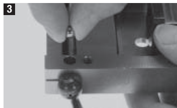
3 Monter akslen med låsepalen i hullet som vist på billedet. Pas på at kuglelejet ikke falder ud.
