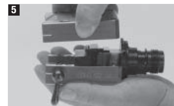
Sätt samman märkhuvudets övre och undre halva och säkra med de 4 låsskruvarna M6x30. Använd Loctite och en insexnyckel.
