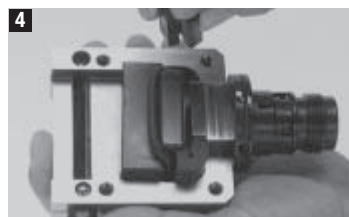
Efter montering av städet, placera dämparna enligt bild.
