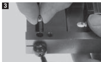
3 Sett på akselen med låsemekanismen i hullet som vist. Pass på at du ikke mister kulelageret.
