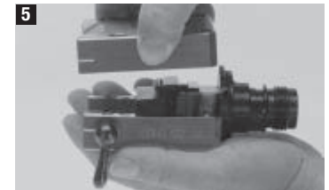
5 Placer la partie supérieure du boîtier sur la partie inférieure et serrer à fond les 4 vis (M6x30) avec du Loctite et une clé pour vis à tête six pans creux.
