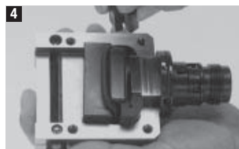
4 Etter at utstøteren er satt på, sett på absorberen som vist.
